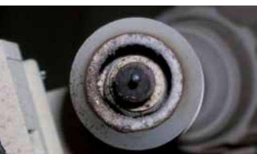
Het verschil mét en zonder de bescherm laag, na 75 minuten lassen
