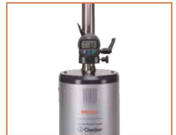
Kalibratie met gebruik van digitale meetklok
