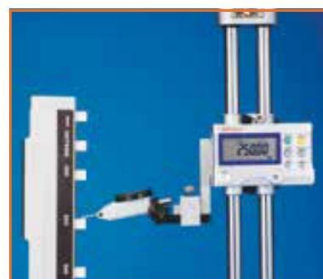
Nauwkeurigheidscntrole van hoogtemeter
