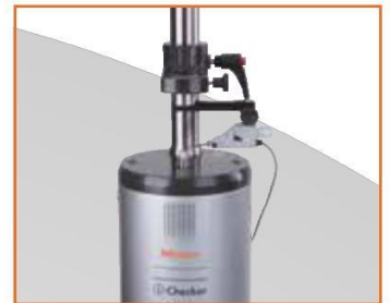
Inspectie met hendeltaster (inductieve sonde)
