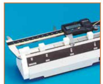
Nauwkeurigheid van schuifmaat controleren (buitenmeting)
